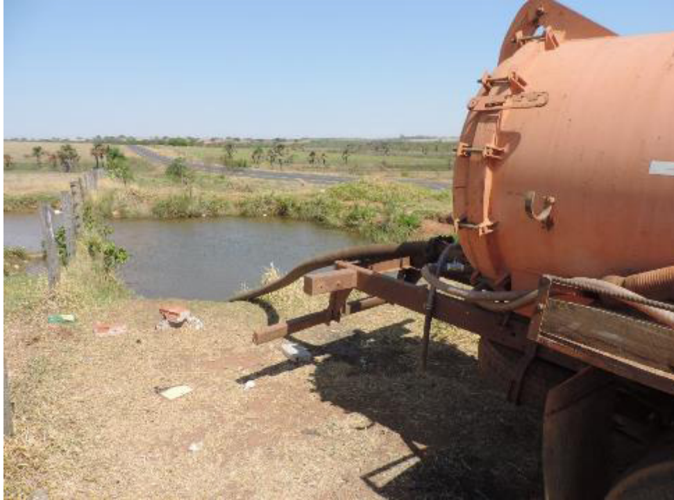
Figura 8 - Tomada de água caminhão tanque no canal artificial.
