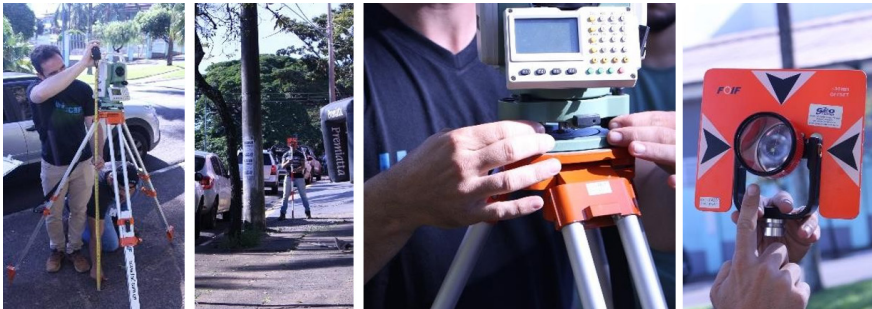
Imagem 2 – Atividades de campo em levantamento planialtimétrico de praça municipal, parte do projeto piloto de extensão
